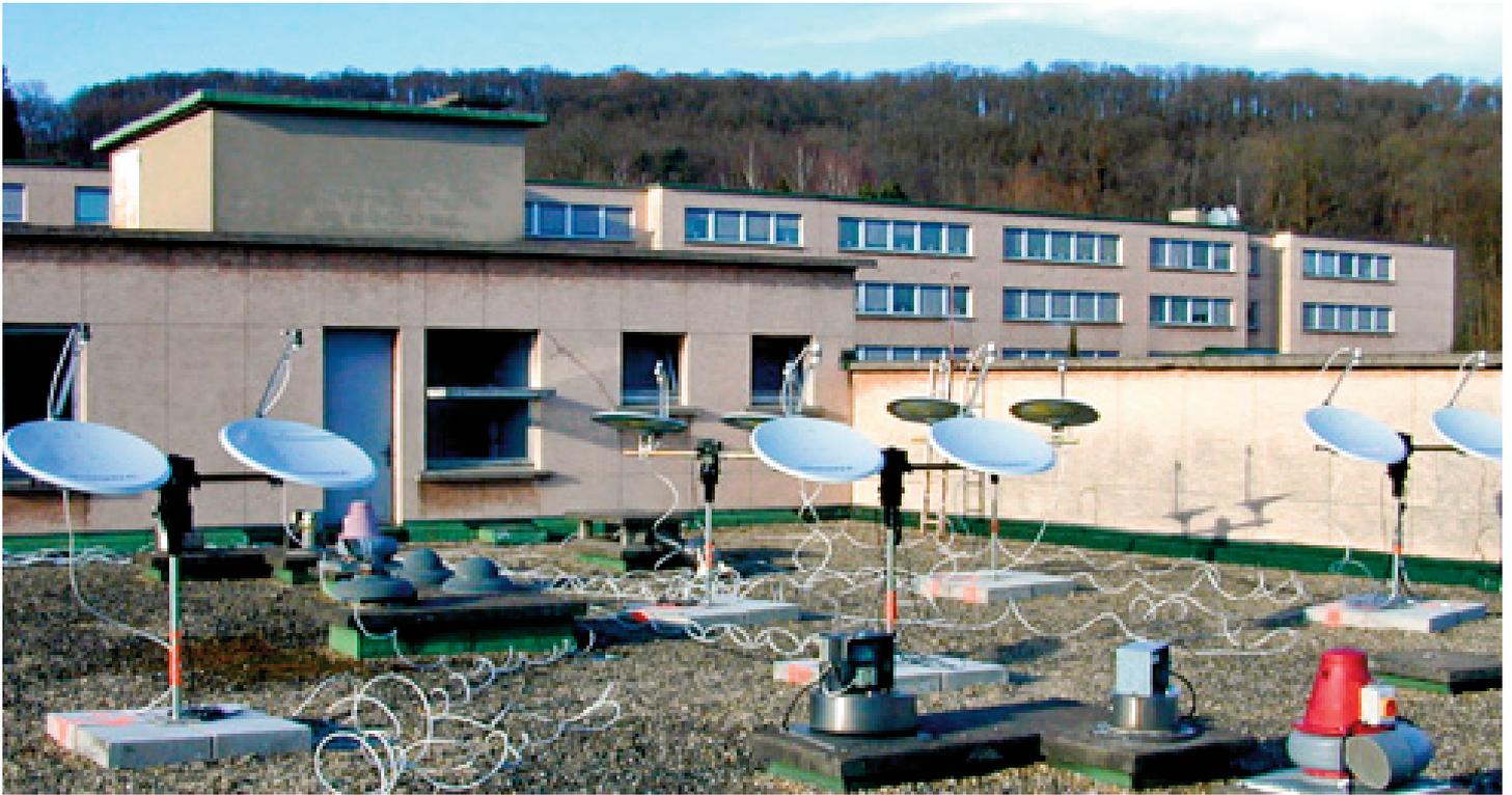
*Les 10 antennes du réseau de radiotélescopes 10 GHz RAMEAU à Orsay. Photo H. Dole*
